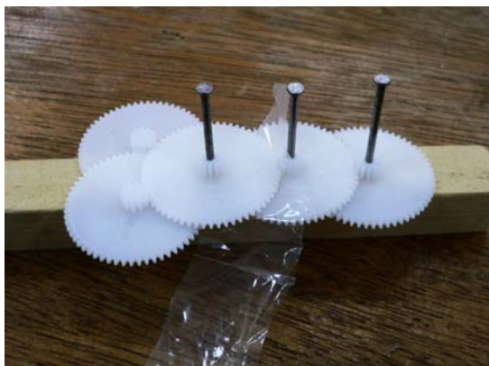
圖 6 訂出第三齒輪的軸心位置
