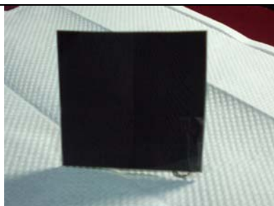
圖 8 未放入液晶小卡，看不到原本寫在後面那片偏光片內側的字
